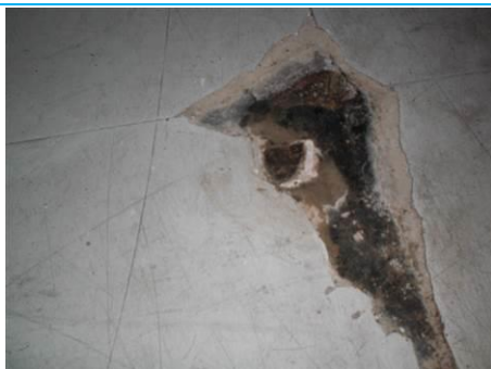
Matériaux : ZPSO-S18 Prélèvement : P030 Description : Colle noire et ragréage sous dalle de sol 30*30 blanche sans amiante Localisation : RdC - 028 Résultat : Présence d'amiante Quantité : 16
