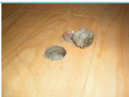
Matériaux : ZPSO-S07 Prélèvement : P008 Description : Ragréage et restes suspectés de colle noire sous lames PVC Localisation : RdC - 006; RdC - 001; RdC - 005 Résultat : Absence d'amiante Quantité :
