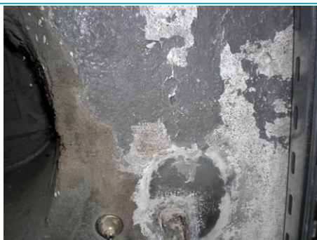
Matériaux : ZPSO-M06 Prélèvement : P093 Description : Enduit ciment périmétrique chaufferie Localisation : RdC - 002 Résultat : Absence d'amiante Quantité : m2
