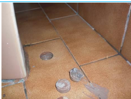
Matériaux : ZPSO-S20 Prélèvement : P035 Description : Colle de carrelage 10*20 caramel et colle grès cérame Localisation : RdC - 020; RdC - 032 Résultat : Absence d'amiante Quantité :
