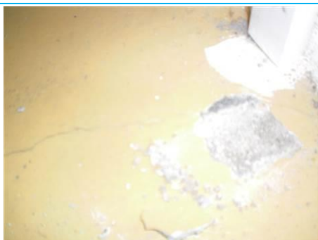
Matériaux : ZPSO-S32 Prélèvement : P076 Description : Colle noire sous peinture de sol et ragréage Localisation : R1 - 013b Résultat : Présence d'amiante
