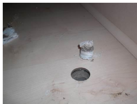
Matériaux : ZPSO-S12 Prélèvement : P016; P048 Description : Dalle de sol et colle noire sous stratifié et ragréage Localisation : RdC - 018; RdC - 021; RdC - 017 Résultat : Présence d'amiante Quantité : 48
