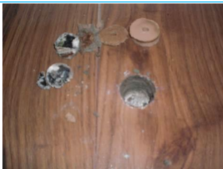
Matériaux : ZPSO-S12 Prélèvement : P016; P048 Description : Dalle de sol et colle noire sous stratifié et ragréage Localisation : RdC - 018; RdC - 021; RdC - 017 Résultat : Présence d'amiante Quantité : 48
