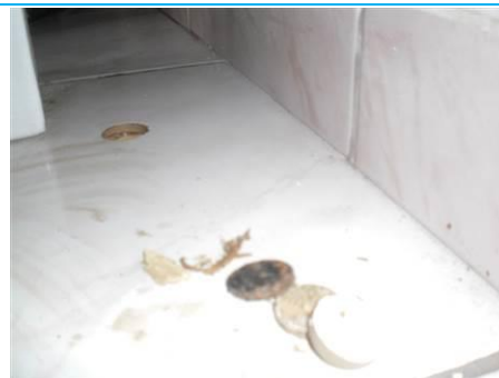
Matériaux : ZPSO-S11 Prélèvement : P019 Description : Dalle de sol et colle noire sous carrelage 32*32 et sol souple Localisation : RdC - 013b Résultat : Présence d'amiante Quantité : 8,5
