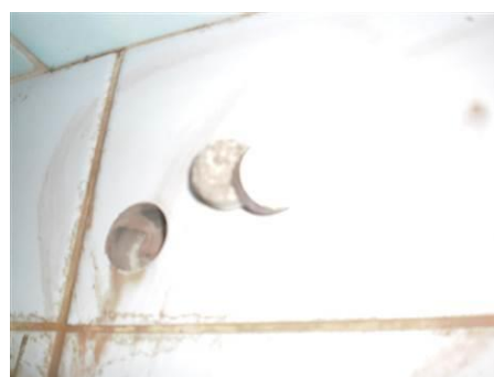
Matériaux : ZPSO-S16 Prélèvement : P026 Description : Colle de carrelage 20*20 bleu ciel et colle grès cérame Localisation : RdC - 026; RdC - 025 Résultat : Absence d'amiante Quantité :
