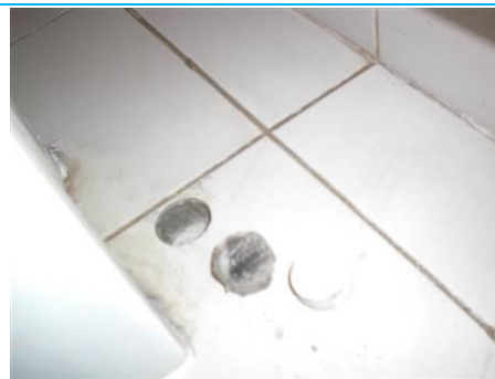
Matériaux : ZPSO-S29 Prélèvement : P070 Description : Colle noire sous carrelage 20*20 blanc Localisation : R1 - 009b; R1 - 009c; R1 - 018b; R1 - 018c; R1 - 032b; R1 - 032c; R1 - 019b; R1 - 019c Résultat : Présence d'amiante Quantité : 12
